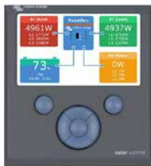
Color Control GX mit Anzeige eines PV-Systems
