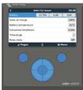
Color Control Der leistungsstarke Linux-Computer, versteckt hinter dem Farbdisplay und Tasten, sammelt Daten von allen Victron-Geräten und zeigt sie auf dem Display an. Abgesehen von dem Datenaustausch mit den Victron-Geräten kommuniziert das Color Control außerdem über CAN-bus (NMEA 2000), Ethernet und USB. Auf dem VRM Portal können Daten gespeichert und analysiert werden.
