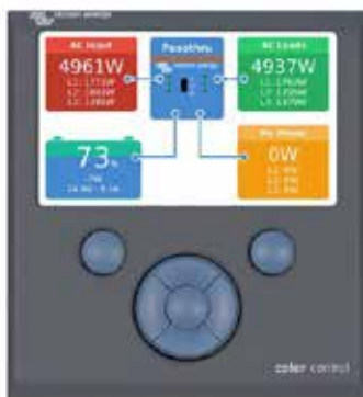
Color Control GX, mit Anzeige eines PV-Systems
