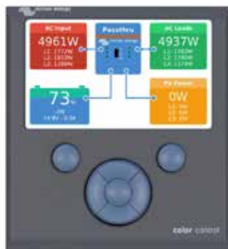
Color Control GX, mit Anzeige eines PV-Systems
