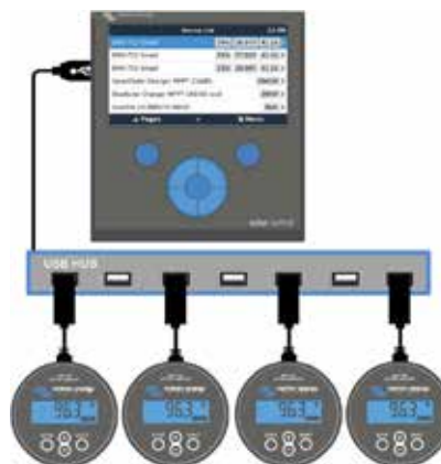
Es können bis zu vier BMVs direkt mit einem Color Control verbunden werden. Es lassen sich sogar noch mehr BMVs an einen USB-Hub anschließen, um zentral überwacht zu werden.
